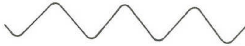
Fig. 8.2. Sinal característico obtido pela reprodução, no gravador de cassettes, da onda quadrada apresentada na figura 8.1
